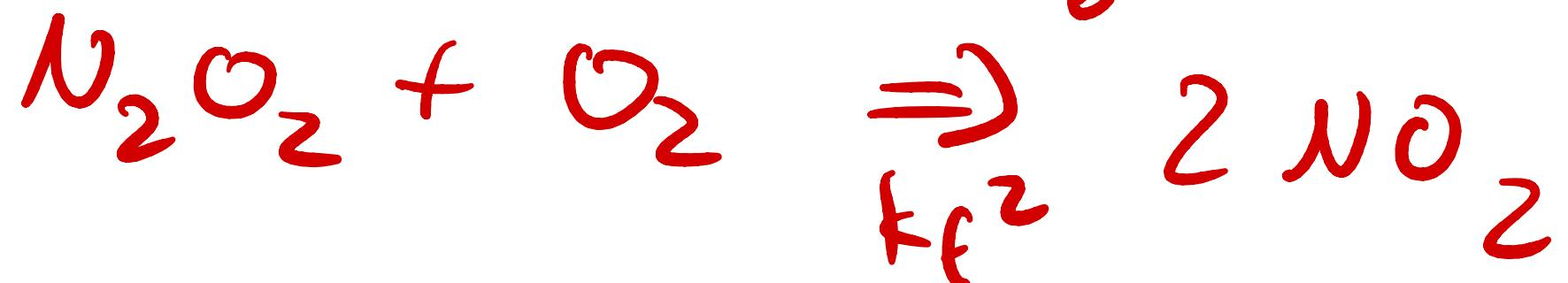
$$\text{rate} = \frac{1}{2} \frac{d[NO_2]}{dt} = k_f^2 \underbrace{[N_2O_2][O_2]}$$
